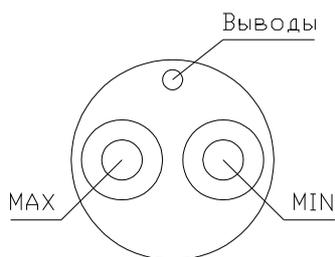
Примечание. После калибровки при выпуске из производства подстроечные резисторы закрываются слоем защитного компаунда.
