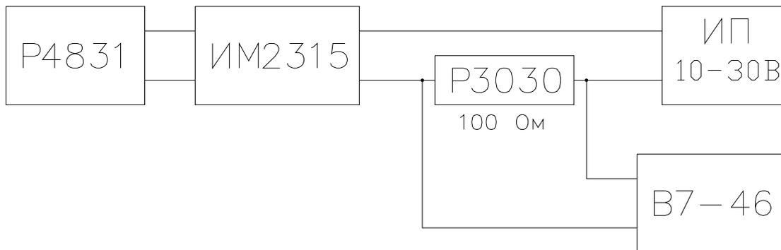
**ПРИЛОЖЕНИЕ 1.2.** Схема подключения преобразователя ИМ2315 при использовании по назначению.
