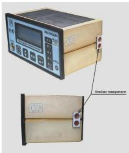
Рисунок 2 – Схема пломбировки комплексов измерительных ИМ2300ГК
